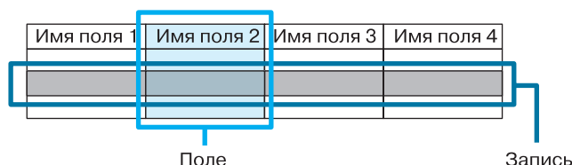
Рис. 3.26. Основные структурные элементы реляционной таблицы
